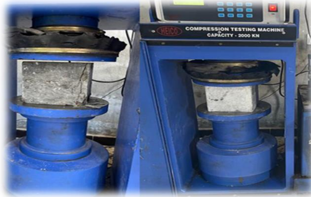
شكل5: يوضح احدى العينات أثناء اختبار مقاومة الضغط
