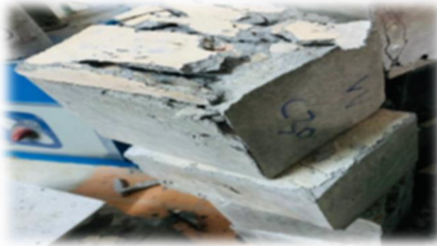
شكل6 : نمط الانهيار لعينة من الخلطة C30
