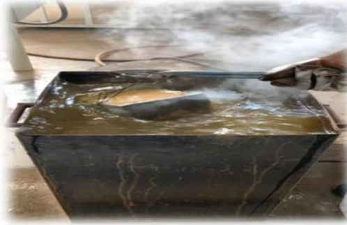
شكل 3: إحدى العينات أثناء التبريد الفوري بالماء
