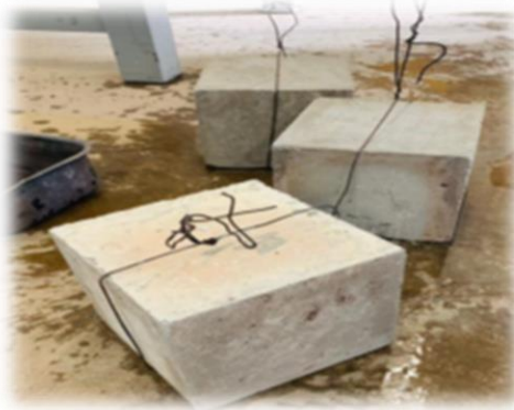
شكل 4 : بعض العينات التي تركت لتبرد في درجة حرارة الغرفة
